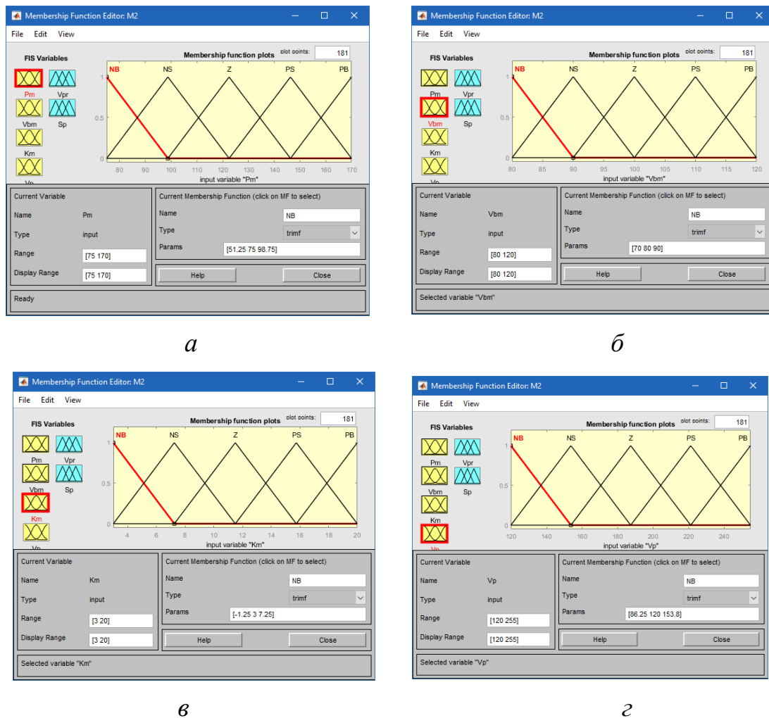
Рис. 3.3. Функції належності нечітких змінних вхідних і вихідних параметрів для продуктивності за вхідною рудою (а), витратою води в млин (б), коефіцієнтом міцності руди (в) й об'ємом циркулюючого навантаження (г)
